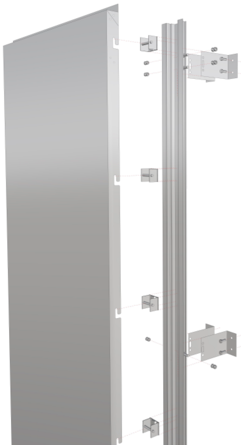
Figure 1b - Principes des cassettes en 3D via le système Omega et Coulisseau
