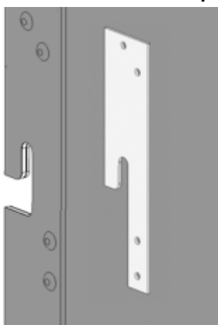
Figure 9 – Renfort d'encoche en centre de la cassette avec une tôle d'angle en aluminium EN AW-5754 t = 2 \text{ mm} ou t = 3 \text{ mm} (cf. du Tableau 4 au Tableau 14 pour plus de précisions)
